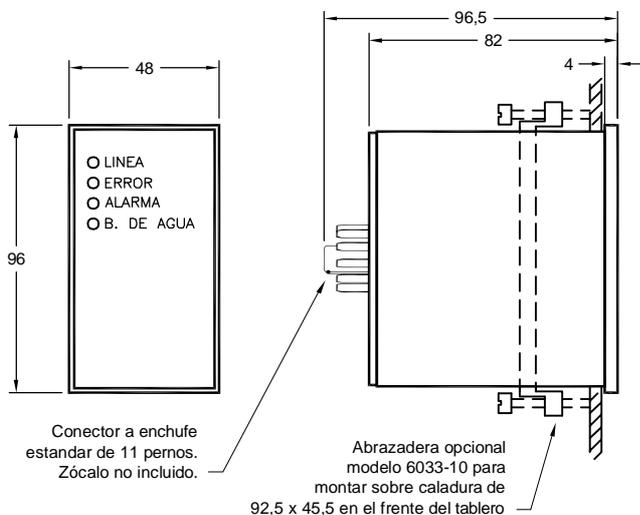
El módulo de control se colocará en el tablero eléctrico de la bomba y el conjunto de electrodos en el tanque. Las longitudes de las varillas se ajustarán para que queden a los niveles deseados. Para su conexión se recomienda utilizar cable de buena calidad de sección no menor que 0,75mm<sup>2</sup> con terminales. Por razones de seguridad los cables de conexión de los electrodos se deben instalar en cañerías diferentes de las de los cables de alimentación u otros cables con 220V.
